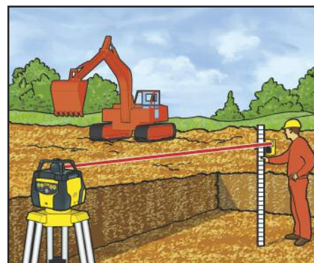
Niwelacja terenu z użyciem odbiornika i łaty pomiarowej
