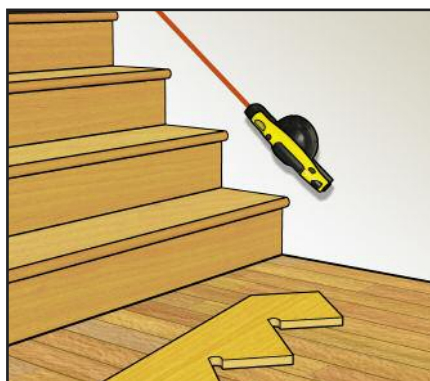
Wyznaczanie linii ukośnej
