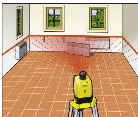
Wyznaczenie płaszczyzn przy pracach montażowych
