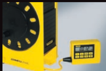
Elektroniczna poziomnica COMPULEVEL
