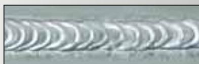
Oblik vala varenja PULSE ON PULSE • Spawanie aluminium metodą MIG PULSE ON PULSE • Sudură MIG PULSE ON PULSE pe aluminiu • Varenje MIG PULSE ON PULSE na aluminiu
