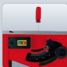
Regulacja kąta tarczy
