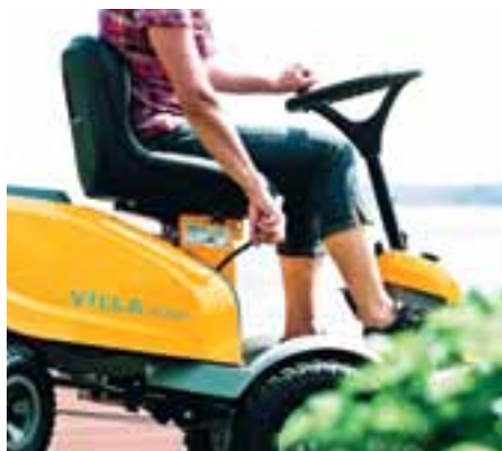
Napęd hydrostatyczny do bezstopniowej regulacji prędkości.
